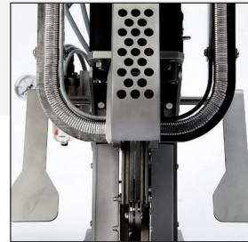
Doble accionamiento neumático para mayor seguridad y velocidad.
