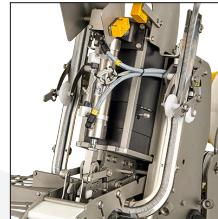
Abnehmbare Haube als Zubehör für eine bessere Reinigung der inneren Teile der Maschine.
