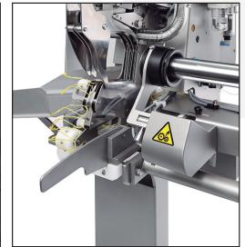
Giro del tubo de embutición para asegurar el centrado del clip con el mínimo esfuerzo.
