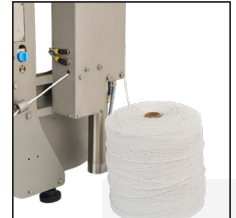
Alimentador cordel sarta para fabricar el embutido en formato herradura.
