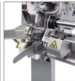
Поворотная цевка гарантирует центрированное положение клипсы при минимальном усилии.
