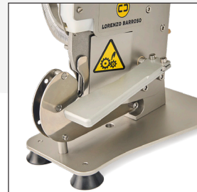
Palanca para el cierre automático del producto.
