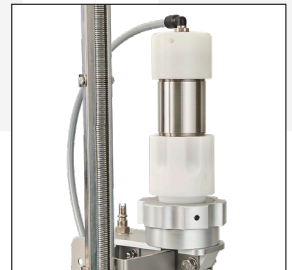
Control del cerrado del clip a través de un excéntrico.
